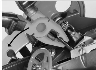
Sollte die Umsteuerfeder an den Metallflappen der Aggregatplatte stoßen, ist diese mittels einer Flachzange leicht nach außen zu biegen.
