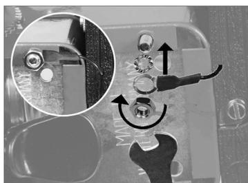
**Montage des Empfängermoduls**
